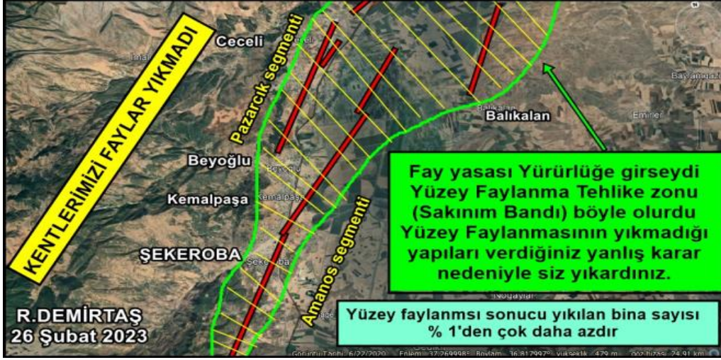
Şekil 16. Pazarçık segmenti ile Amanos segmentleri arasındaki sıçrama bölgesi için önerilecek sakinim bandı (Demirtaş, 2023)
