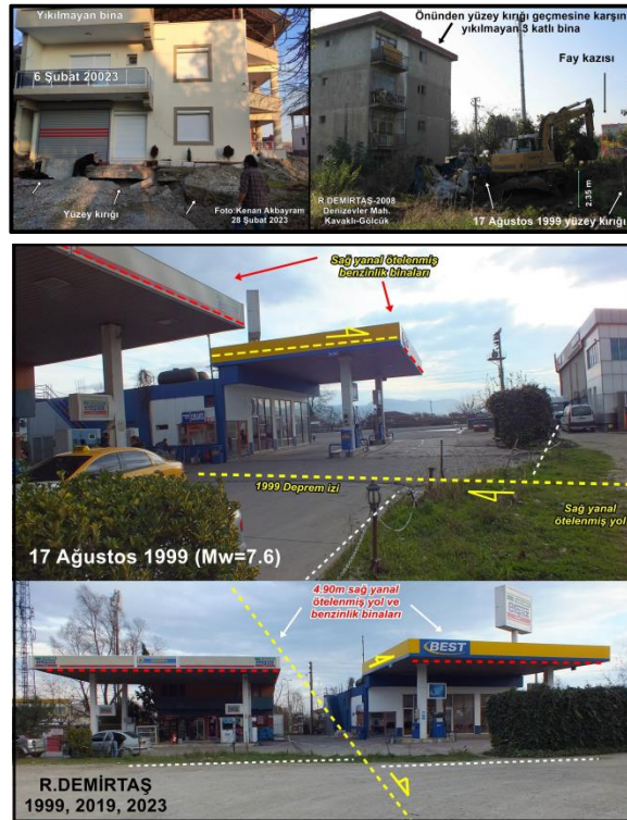
Şekil 17. 17 Ağustos 1999 ve 6 Şubat 2023 depremlerinde, alüviyal zeminler üzerinde yer alan faylanmalar bitişinde yıkılmayan düşük katlı binalar (Demirtaş, 2023)
