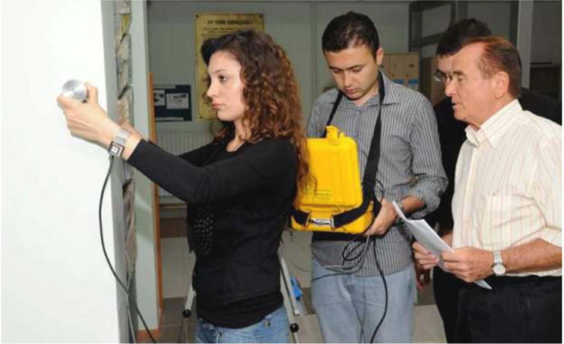
Şekil 2. - Bir Betonarme kolonda Ultrases Vp – boyuna dalga hızının ölçülmesi
